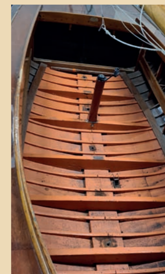
Omdat de boot vanuit zijn oude ligplek over het water naar de kraan moest worden de naden afgeplakt.
