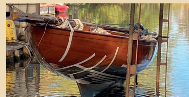
Omdat de boot vanuit zijn oude ligplek over het water naar de kraan moest worden de naden afgeplakt.
